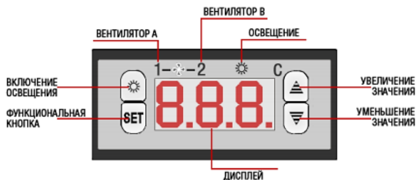
Рисунок В4 – Панель управления системы термоконтроля
