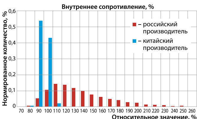
• Рис. 12 Нормированный разброс значений внутреннего сопротивления сравниваемых аккумуляторов
