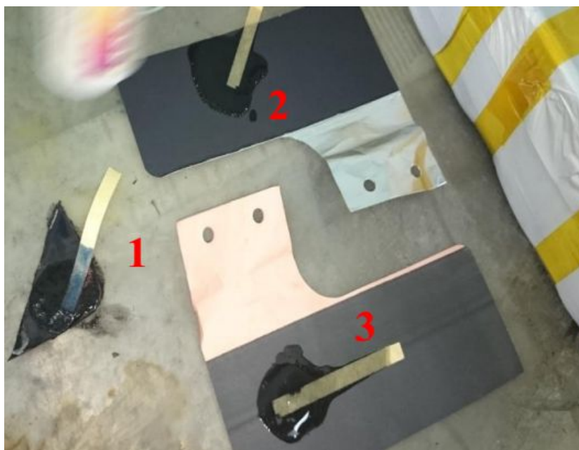
Рисунок 4.1 – Результаты химического анализа катода аккумулятора, подвергшегося перезаряду (1), а также катода и анода нормального аккумулятора (2) и (3)
